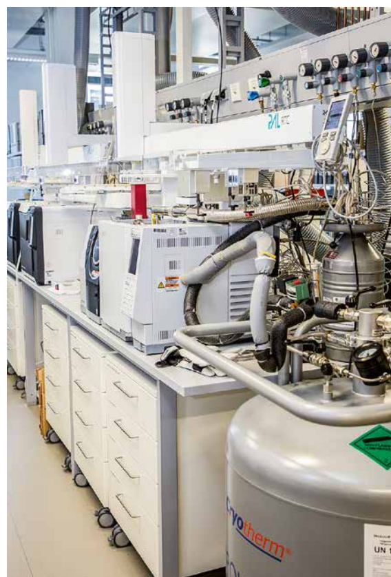
Abb. 1.10: Analysegeräte zur automatisierten Prüfung der Speiseölauthentizität (GC-FID und SPME-GCxGC-MS)
