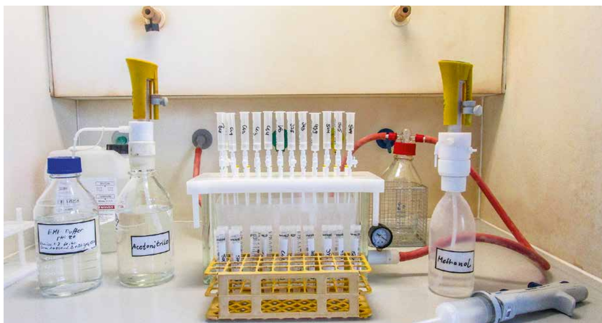
Abb. 1.26: Aufbau der Festphasenextraktion zur Aufreinigung von Probenextrakten
