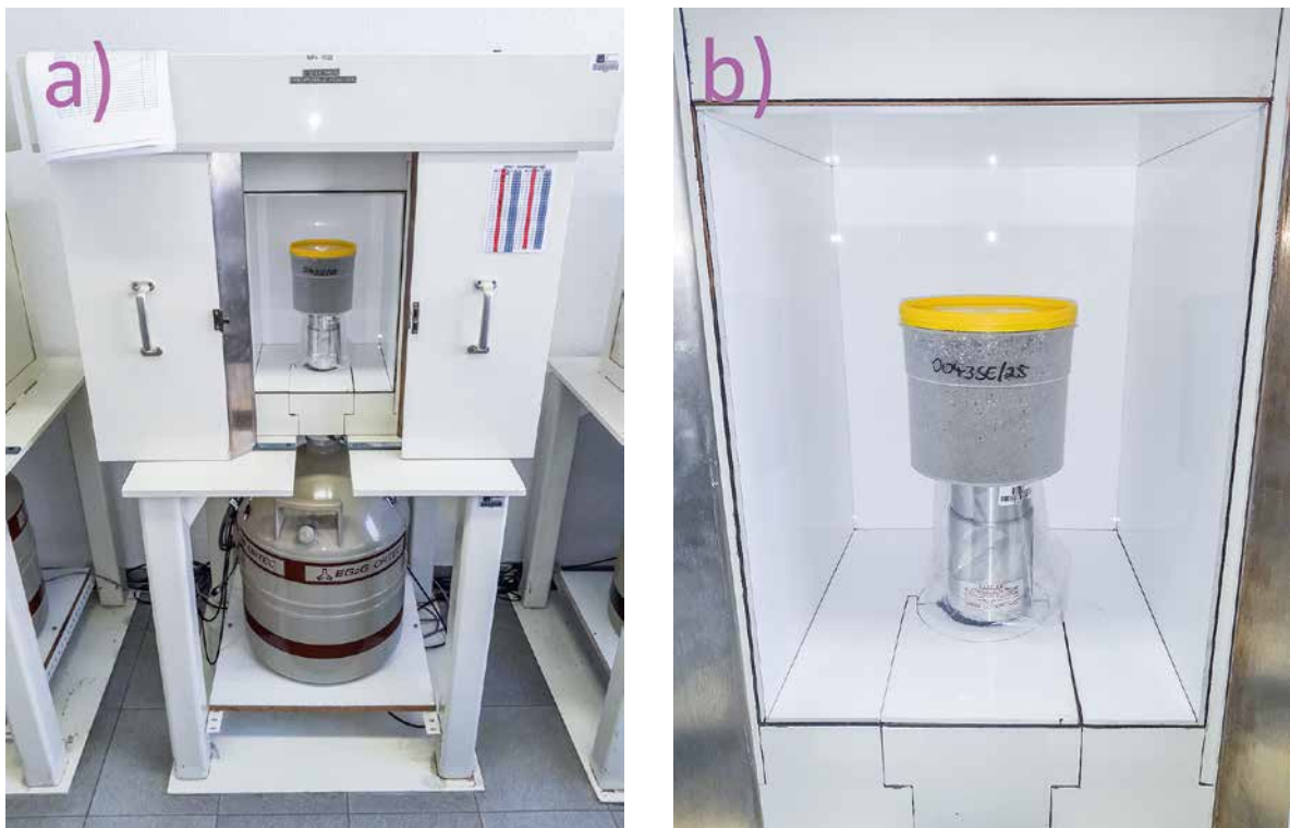
Abb. 4.1: a) Hochauflösender, mit flüssigem Stickstoff gekühlter Reinstgermanium-Halbleiterdetektor in einer Bleiabschirmung. b) Der Detektor befindet sich in einer Bleiburg, auf dem Detektor ist eine aufbereitete Probe in einer 1-Liter-Ringschale gestellt (wie in a)).
